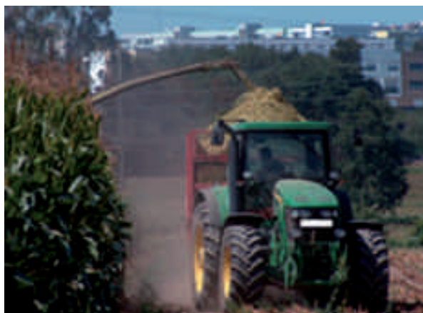
Figura 90 - Utilização de um trator com cabina fechada em tarefas onde existe a libertação de poeiras
